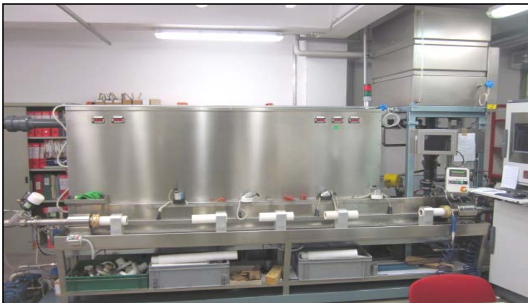
Foto del banco elettronico automatico ETB06 per la taratura di contatori di acqua e di energia termica.
